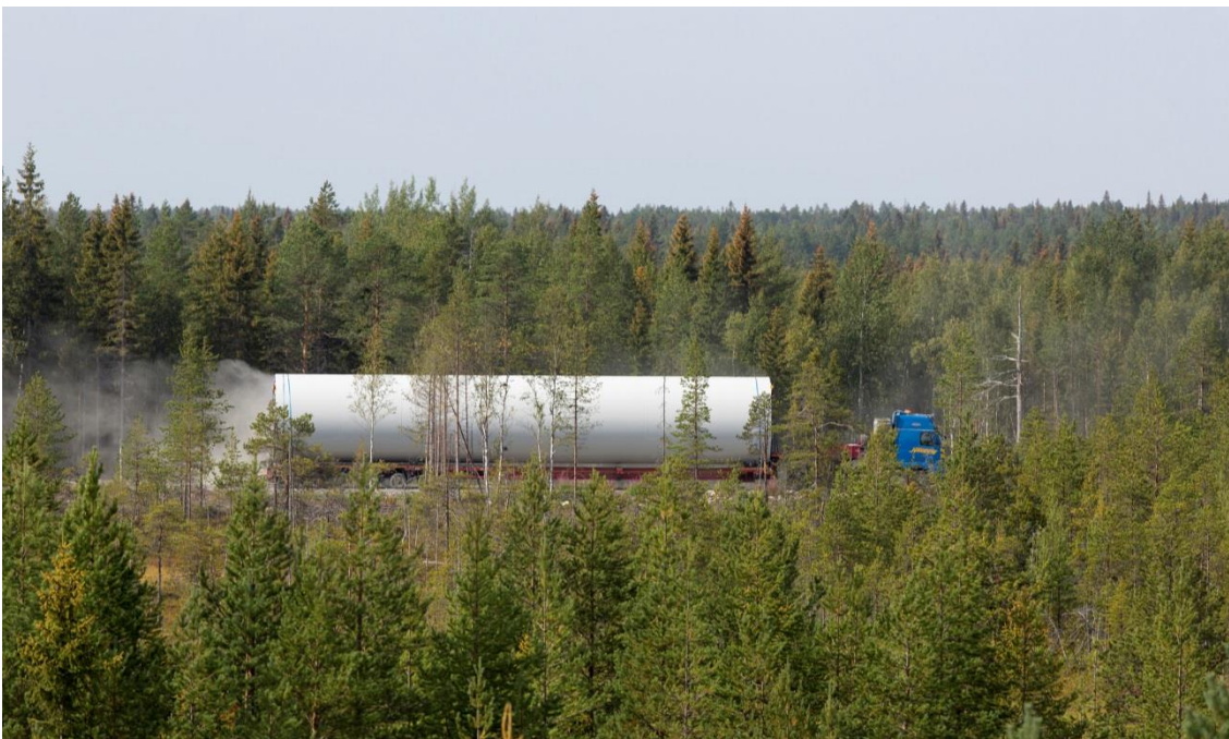
Kuva 4-17. Tuulivoimalan torniosien kuljetusta. (Kuva: FCG).
