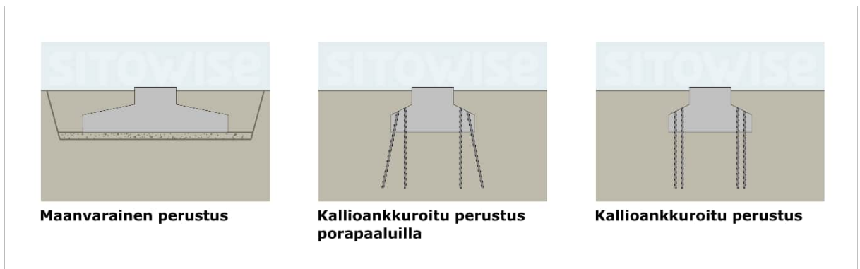
Kuva 3-2 Periaatekuva tuulivoimalan vaihtoehtoisista perustamistavoista.
