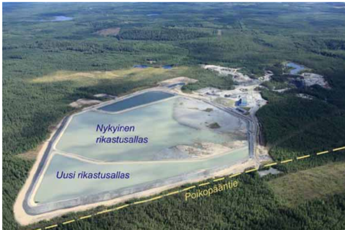
Kuva 130. Uusi rikastushiekka-allas nykyisen rikastushiekka-altaan ja Poikopääntien välissä kuvasovitteena. (kuva:Kaija Maunula)
