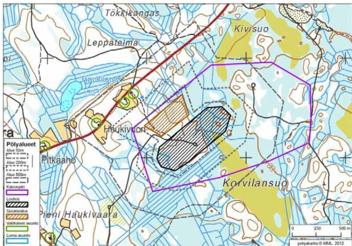
Kuva 26. Hiukaspäästöjen leviäminen Korvilansuon alueella. Pitoisuudet 50 m etäisyydellä lähdealueesta ylittävät ilmanlaadun hengitettävien hiukkasten vuorokausikeskiarvon raja-arvon 50 \mu\text{g}/\text{m}^3 .
