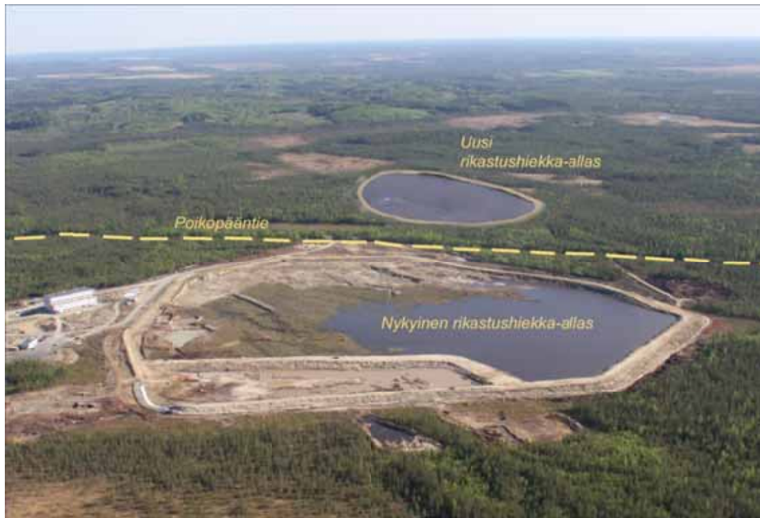
Kuva 129. Uusi rikastushiekka-allas Poikopääntien eteläpuolella kuvasovitteena (aluevaraus 1). (kuva: Kaija Maunula)
