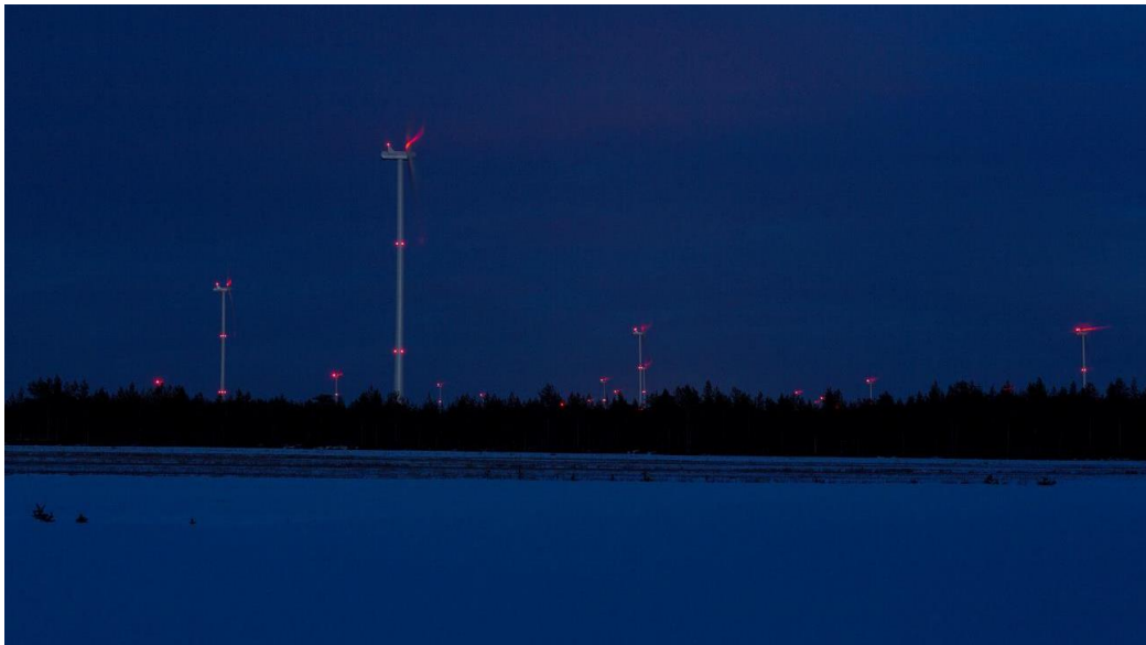
Kuva 5-5 Valokuvassa kiinteät punaiset lentoestevalot (FCG Finnish Consulting Group Oy).
