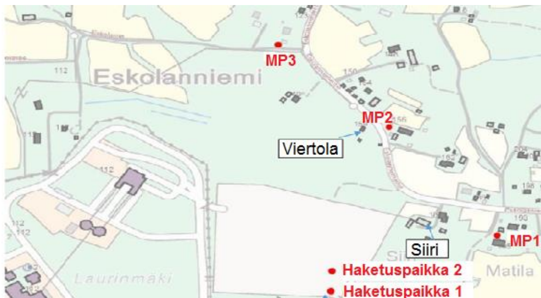
Kuva 5-14. Vuosina 2012-2014 tehtyjen melumittausten mittauspajat ja mobiilihakkureiden sijainnit.
