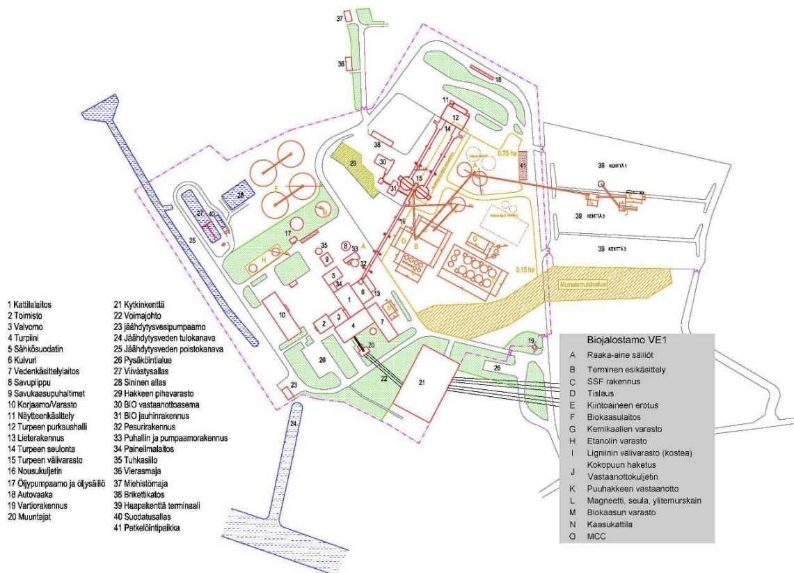
Kuva 2-5. Bioetanolilaitoksen alustava asemapiirros. Suurempi kuva selostuksen liitteessä 4.
