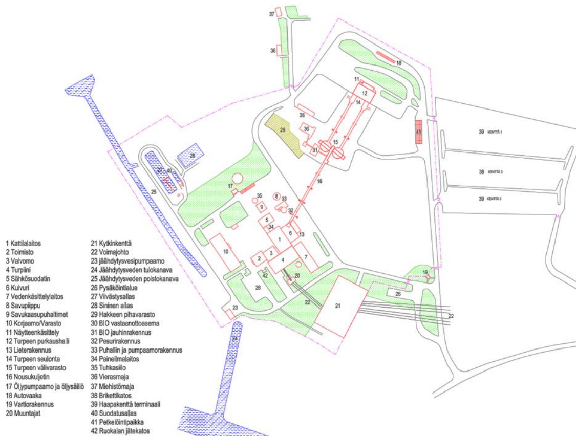
Kuva 2-3. Haapaveden voimalaitoksen asemapiirros. Suurempi kuva selostuksen liitteessä 4.
