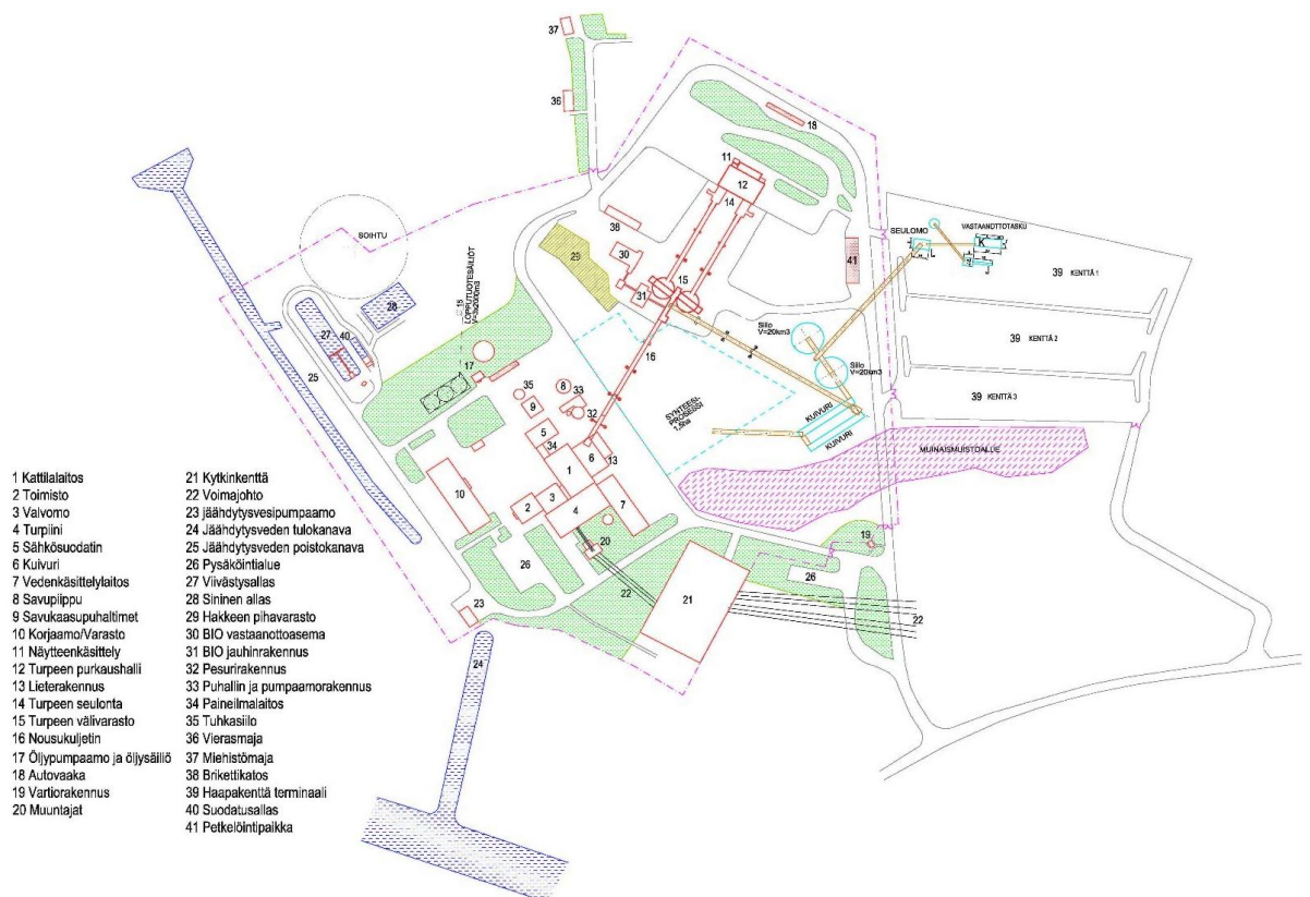
Kuva 2-9. Synteesiprosessiin perustuvan bioöljylaitoksen alustava asemapiirros. Suurempi kuva selostuksen liitteessä 4.
