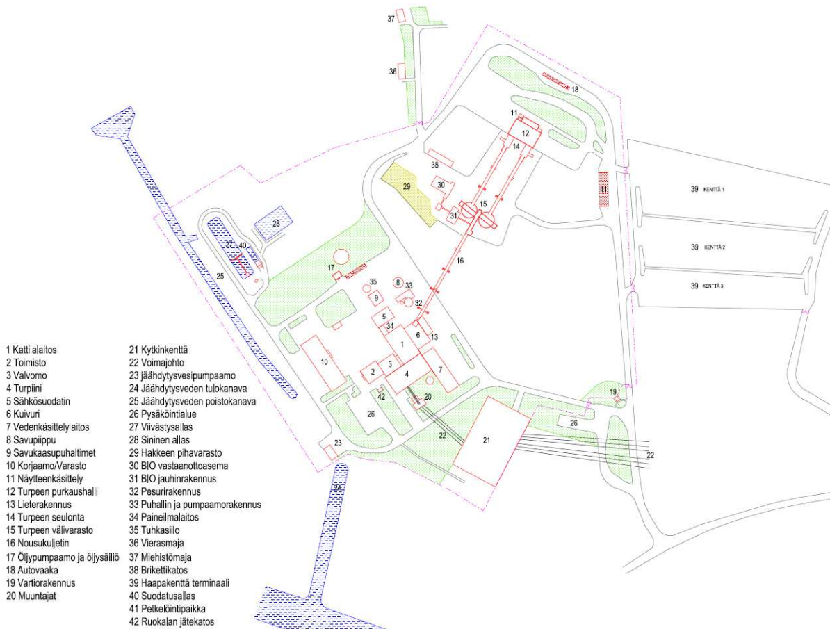
Kuva 3-1. Haapaveden voimalaitoksen asemapiirros.
