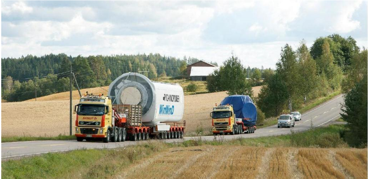
Kuva 104. Tuulivoimalan konehuoneen ja navan erikoiskuljetukset (Ville Silvasti Oy).
