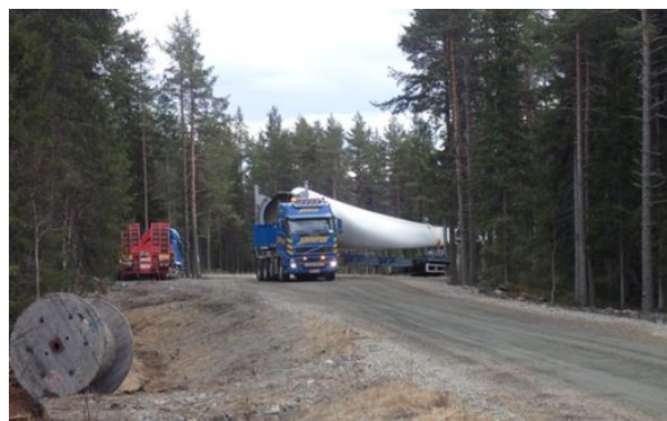
Kuvapari 4.7. Vasemmalla: Esimerkki tuulivoimapuiston rakennus- ja huoltotiestä. Maakaapeli sijoitetaan ojakaivantoon tien reuna-alueelle. Oikealla: Tuulivoimalan osia kuljetetaan erikoiskuljetuksina. (Kuvat: FCG).
