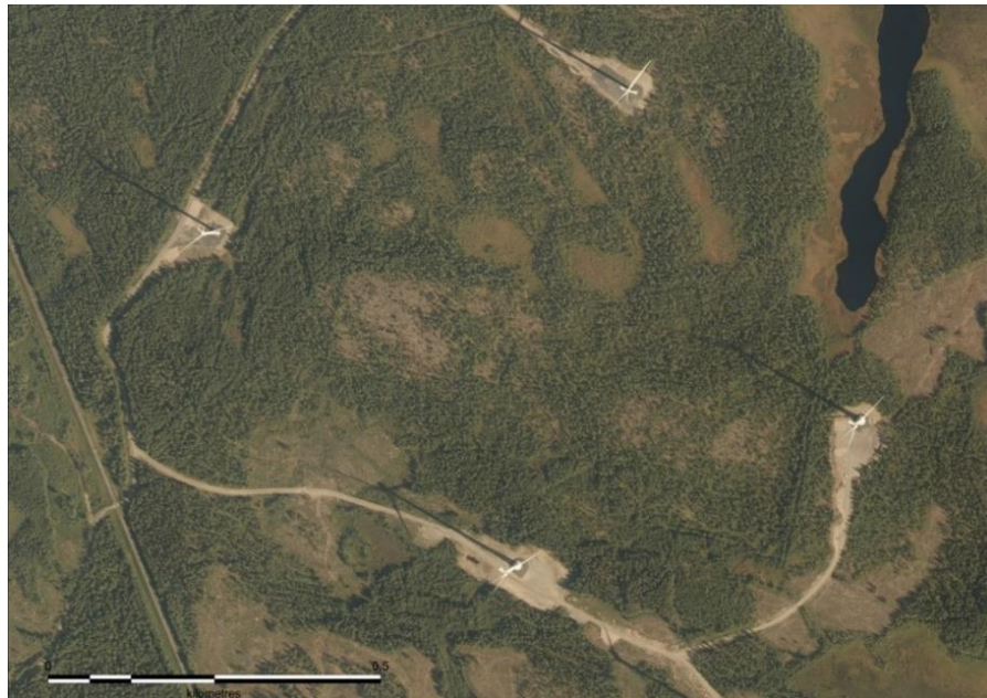
Kuva 12. Ilmakuvassa näkyy toiminnassa olevia tuulivoimaloita. Tuulivoimaloita varten on rakennettu huoltotiet ja nostokentät. Tuulivoimaloiden ympäristössä ja välialueilla aikaisempi maankäyttö on säilynyt ennallaan. (Maanmittauslaitos, ortoilmakuva) Kuva ei ole Kairinevan ja Peränevan alueelta.
