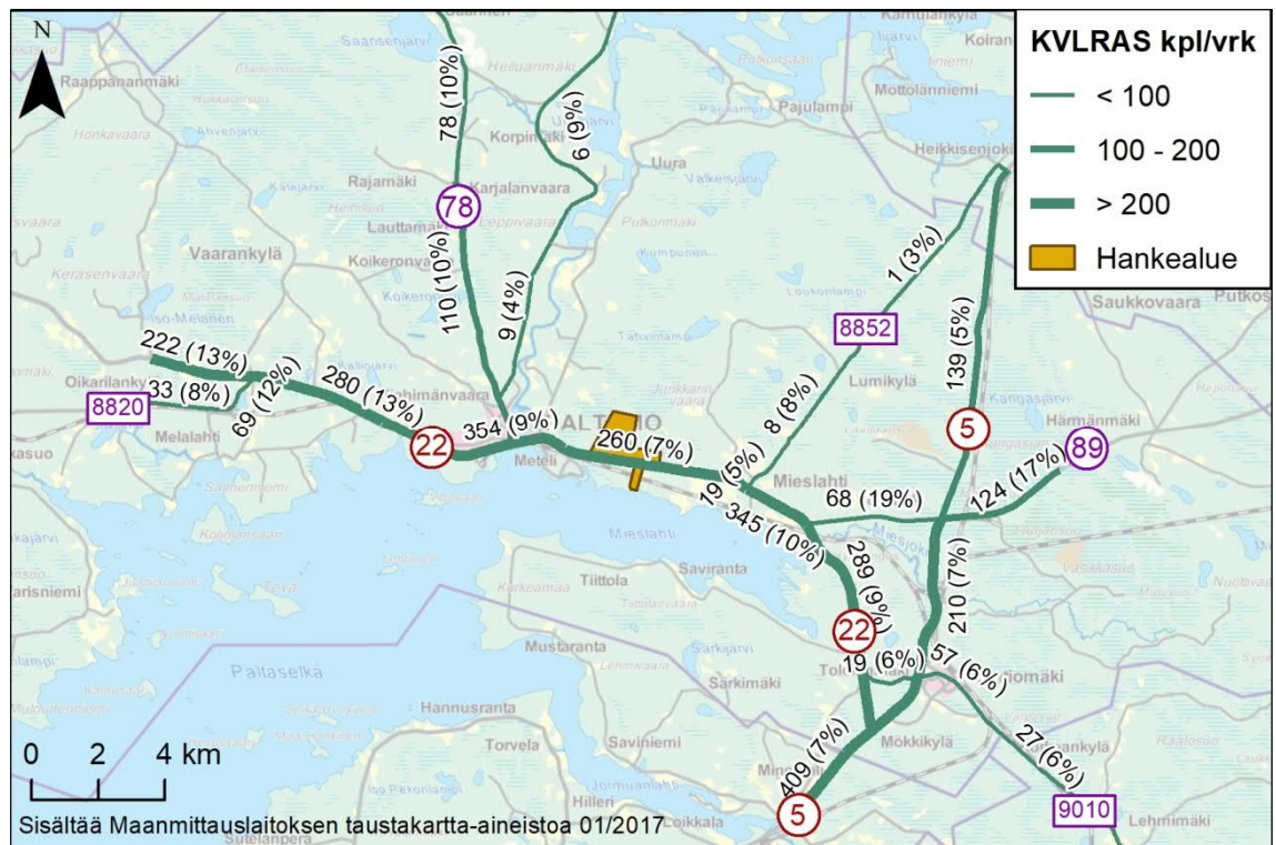
Kuva 9-1. Liikennemäärät vuonna 2016 (KVL: keskimääräinen vuorokausiliikenne). Ylempi kuva: kaikki liikenne, alempi kuva: raskas liikenne. Raskaan liikenteen osuus kaikesta liikenteestä on esitetty prosentiosuuksina. Tiedot: Liikennevirasto 2017.
