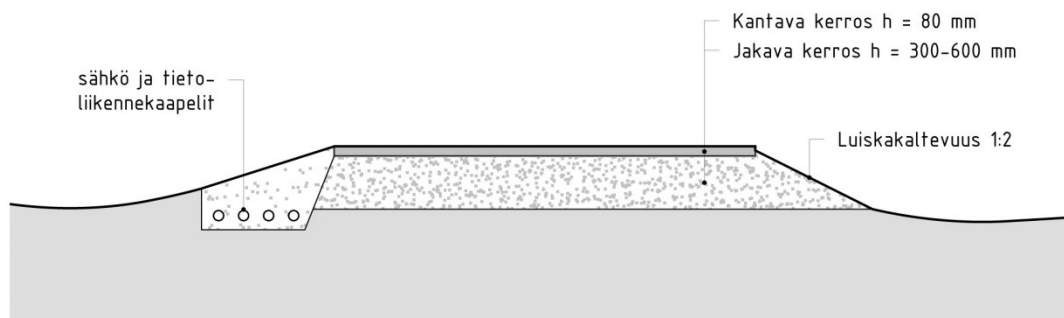
Periaatekuva uuden ja perusparannettavan tien rakenteesta.
