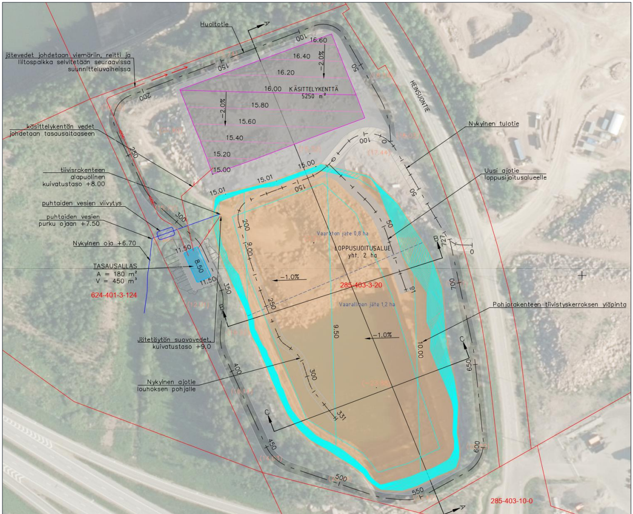
Kuva 5. Suunnitelmakartta tiivistyskerroksen (kaatopaikan pohjarakenne) tasosta vaihtoehdossa VE2a.
