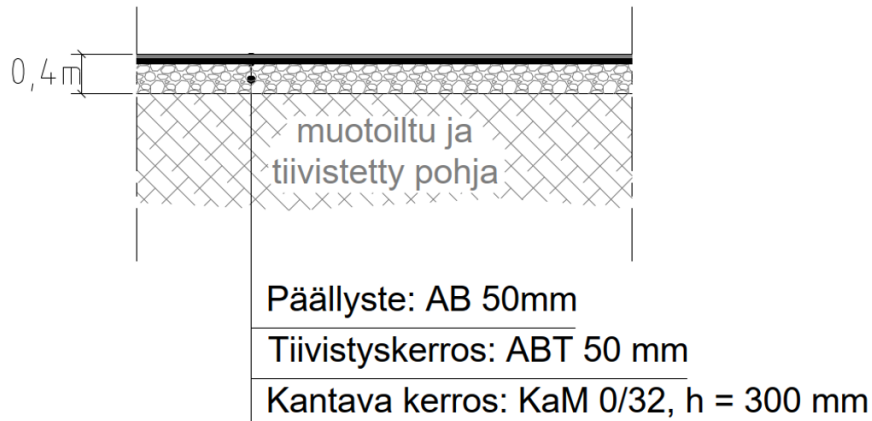
Kuva 18. Käsittelykentän pohjarakenteen periaatekuva vaihtoehdossa VE2a.
