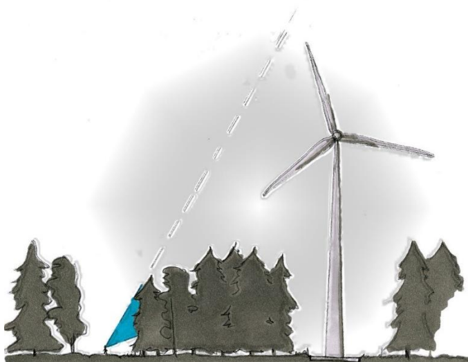
Bild 44. Principbild över synligheten av ett vindkraftverk.
