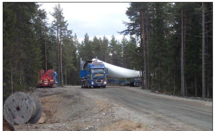
Kuva 2.17. (Vasemmalla) Esimerkki tuulivoimapuiston rakennus- ja huoltotiestä rakentamisaikana. Teitä käytetään muun muassa betonin, soran ja voimaloiden komponenttien kuljetuksiin sekä tuulivoimapuiston käyttövaiheessa huoltoajoihin. Maakaapeli sijoitetaan ojakaivantoon tien reuna-alueelle. (Oikealla) Tuulivoimalan osia kuljetetaan erikoiskuljetuksina. (Kuvat: Ville Suorsa / FCG).
