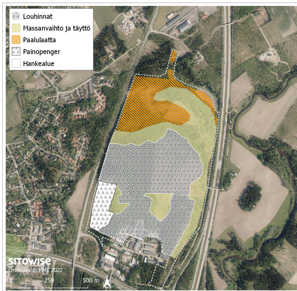
Kuva 8. Alueet, joilla logistiikkakeskuksen mahdollistavia maanrakennustöitä suoritetaan.
