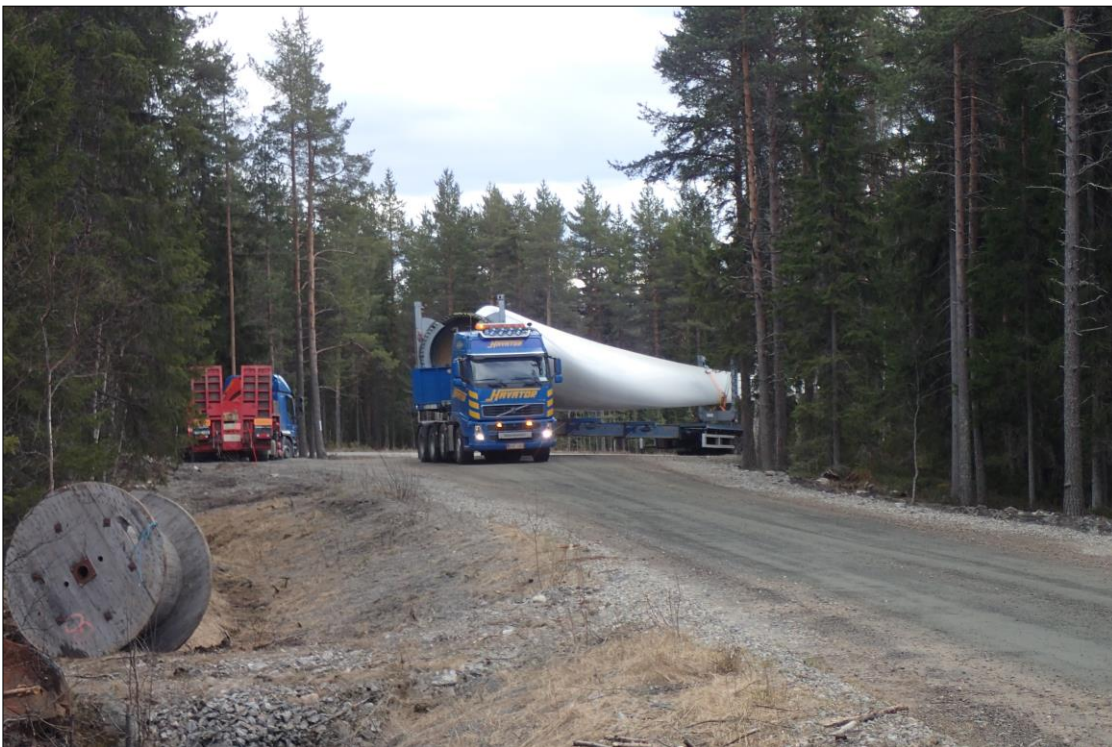
Kuva 5.6. Tuulivoimalan osia kuljetetaan erikoiskuljetuksina. (Kuva: Ville Suorsa, FCG).
