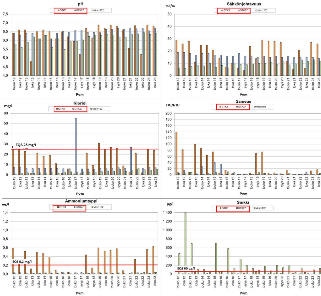
Kuva 8-6. Pohjaveden laatuparametrit (pH, sähkönjohtavuus, kloridi, sameus, ammoniumtyppi ja sinkki) havaintoputkissa GTK3 (oranssit pylväät) ja GTK27 (vaaleansiniset pylväät) tarkkailujaksolla 2012-2023 (Pohjanmaan vesi ja ympäristö ry, 2024).
