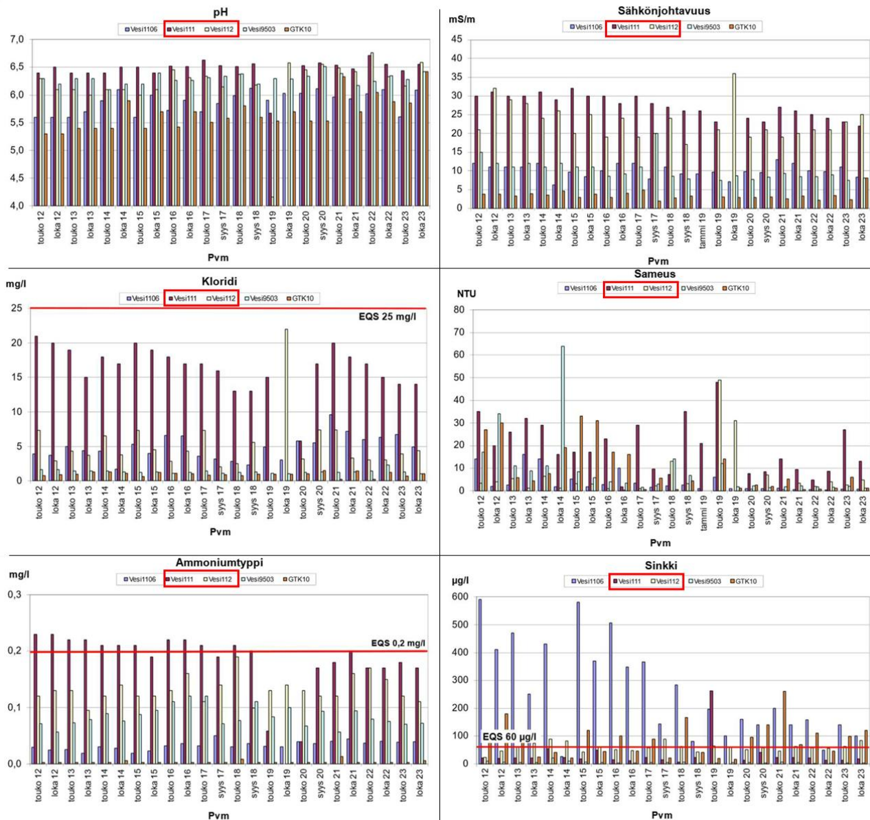
Kuva 8-9. Pohjaveden laatuparametrit (pH, sähkönjohtavuus, kloridi, sameus, ammoniumtyppi ja sinkki havaintoputkissa Vesi111 (tummanpunaiset pylväät) ja Vesi112 (keltaiset pylväät) tarkkailujaksolla 2012-2023 (Pohjanmaan vesi ja ympäristö ry, 2024).
