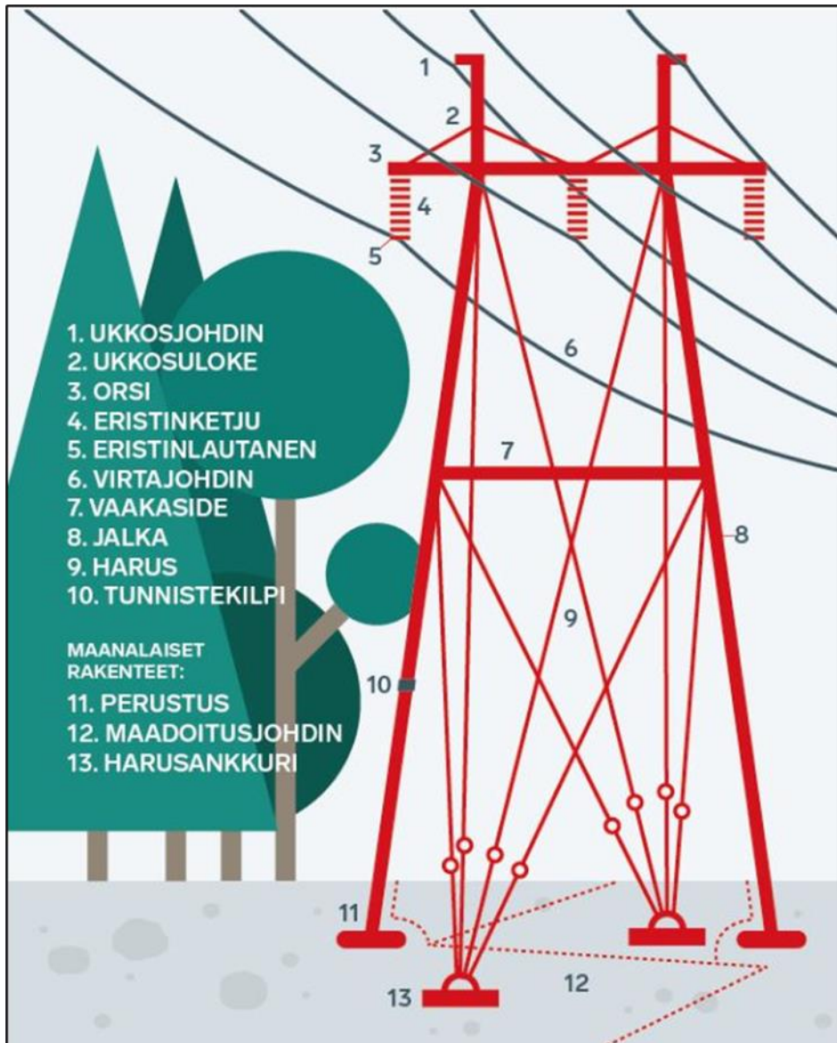
Kuva 2-2. Voimajohtopylvään osat (Fingrid, 2024e).
