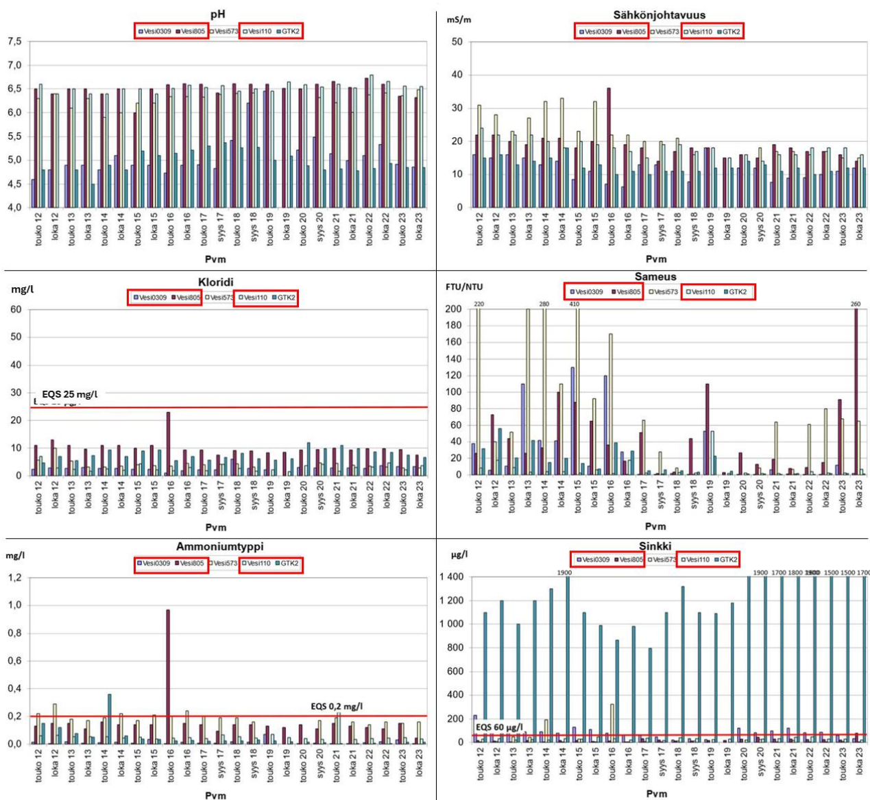
Kuva 8-8. Pohjaveden laatuparametrit (pH, sähkönjohtavuus, kloridi, sameus, ammoniumtyppi ja sinkki) havaintoputkissa Vesi0309 (violetit pylväät), Vesi805 (tummanpunaiset pylväät), Vesi110 (vaaleansiniset pylväät) ja GTK2 (turkoosit pylväät) tarkkailujaksolla 2012–2023 (Pohjanmaan vesi ja ympäristö ry, 2024).
