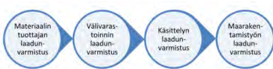
Kuva 15. Materiaalintuottajan laadunvarmistusketju tuhkarakentamiselle (Kiviniemi ym. 2012).
