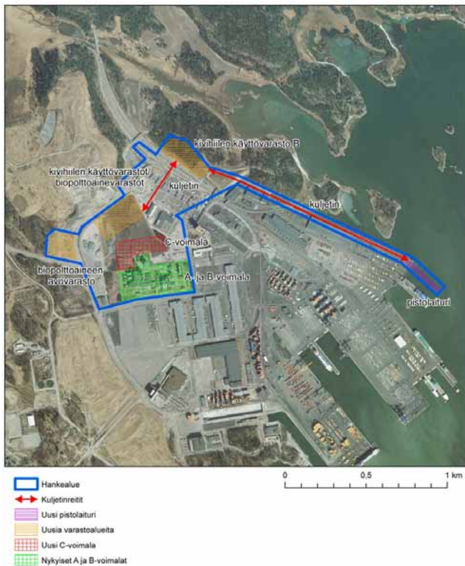
Kuva 5-2. Hankkeen toimintojen sijoittuminen, kivihiilen käyttövaraston sijaintivaihtoehto B.
