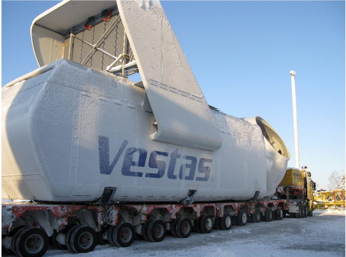
Kuva 88. Tuulivoimalan navan ja nasellin erikoiskuljetus. © Ville Silvasti Oy
