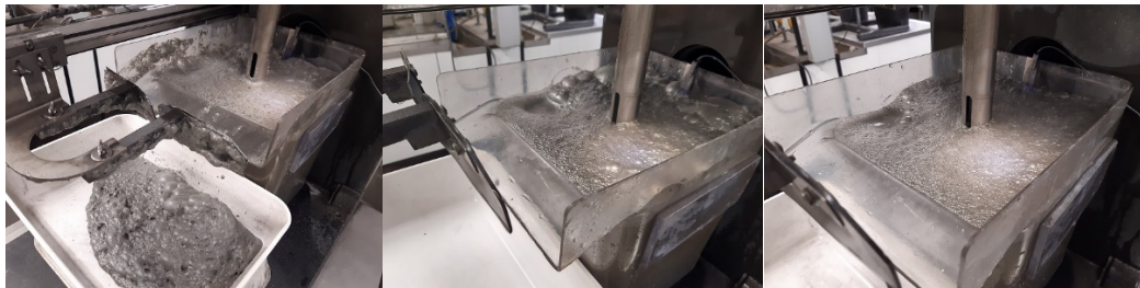
Kuva 4. Kuparin esivaahdotus vaiheittain, CuRC1-3.
