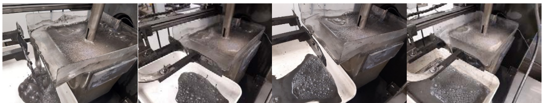
Kuva 5. Nikkelin ja kobolttin esivaahdotus vaiheittain, NiRC1-4.
