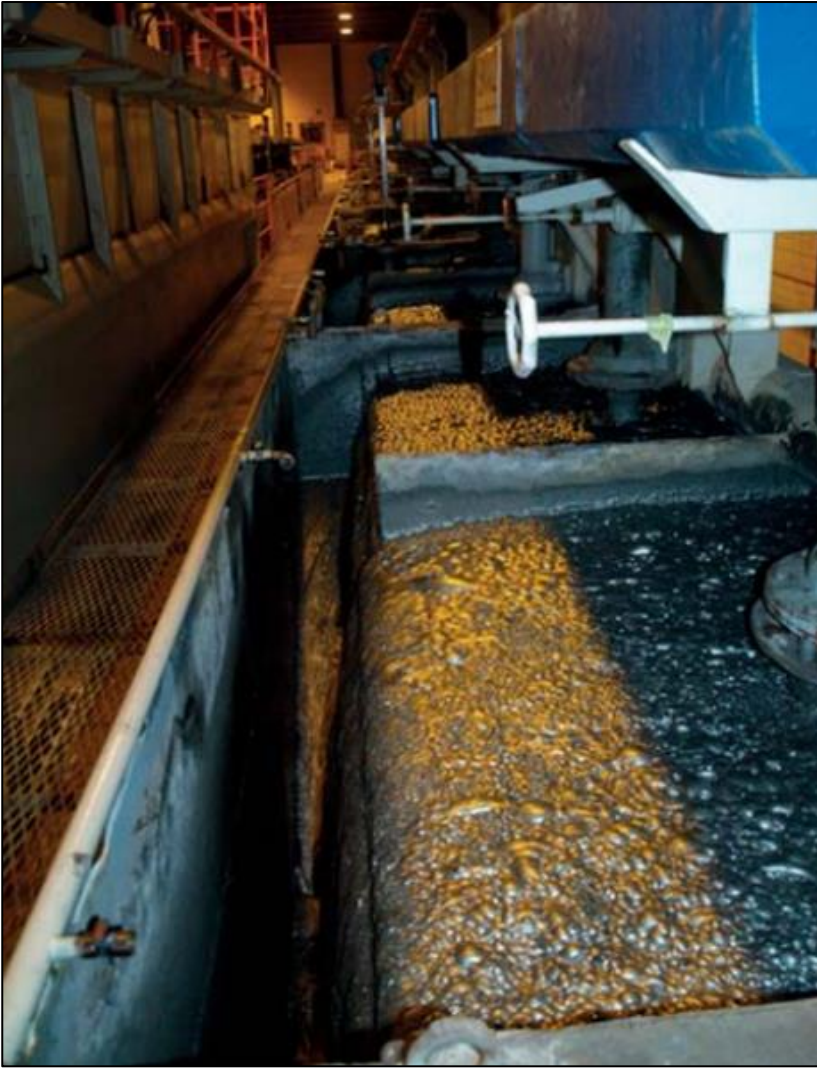
Kuva 26. Esimerkki vaahdotusprosessista (kuva: Boliden Kylylahti Oy, Luikonlahden rikastamo, Envineer Oy)
