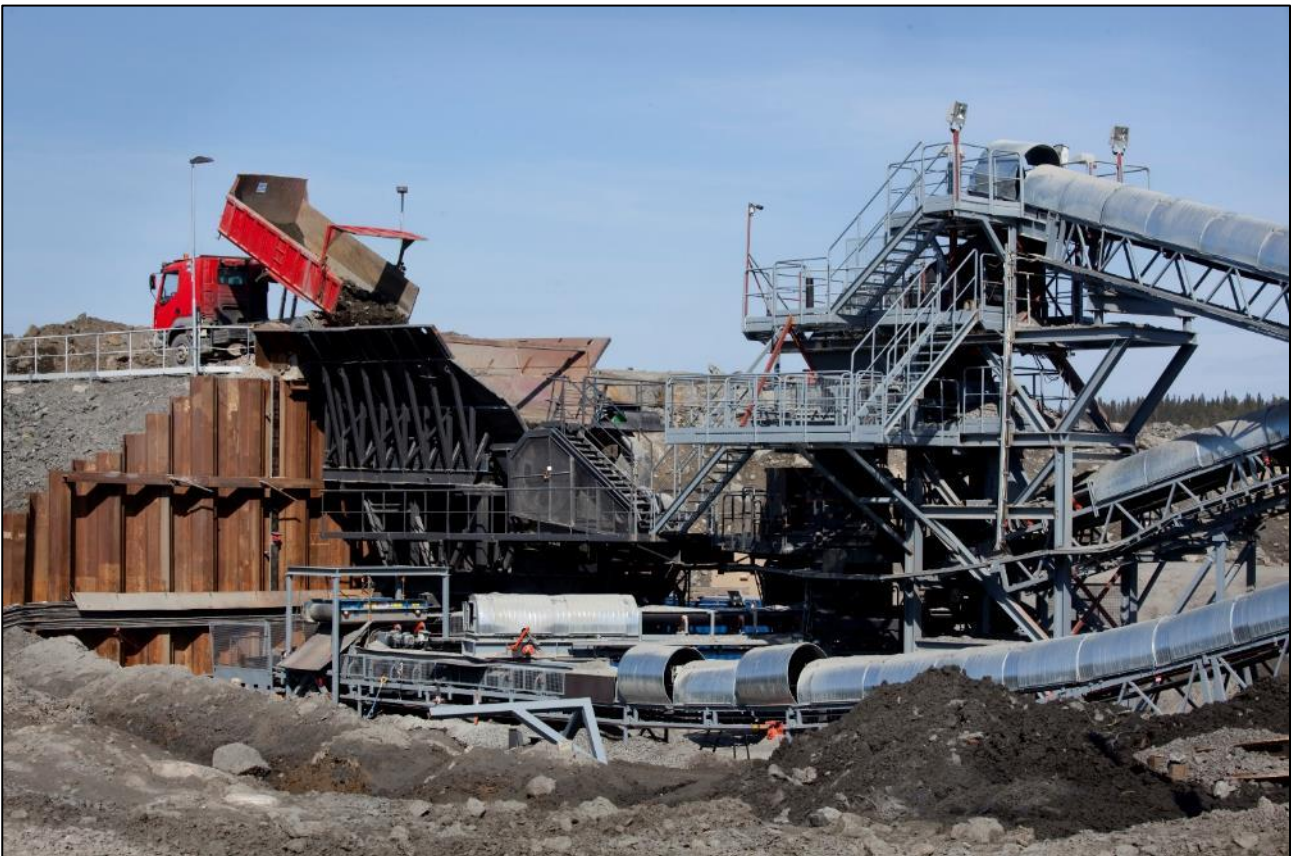
Kuva 21. Esimerkki malmin murskauslaitoksesta Pampalon rikastamolla. Pampalon murskaamo on toteutettu ilman suojarakennuksia. Hautalammen murskaamojen ympärille tulee rakennukset ja pölynpoisto. (Pampalon rikastamo, Endominex Oy)
