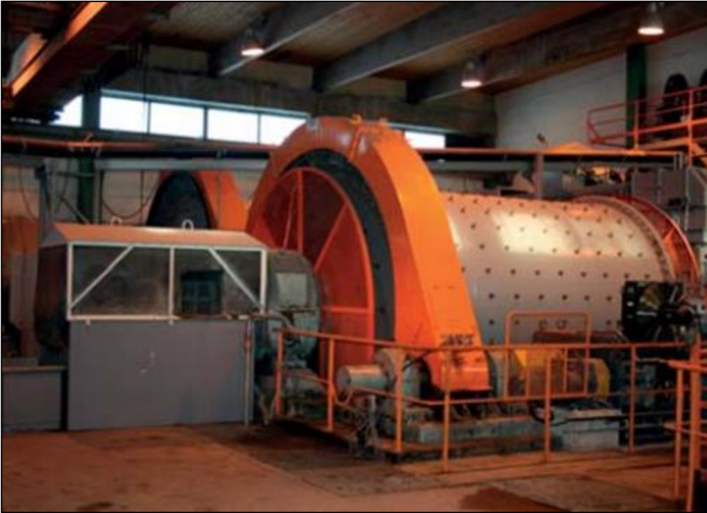
Kuva 25. Esimerkki malmin jauhatuksesta (Boliden Kylylahti Oy, Luikonlahden rikastamo, Envineer Oy)
