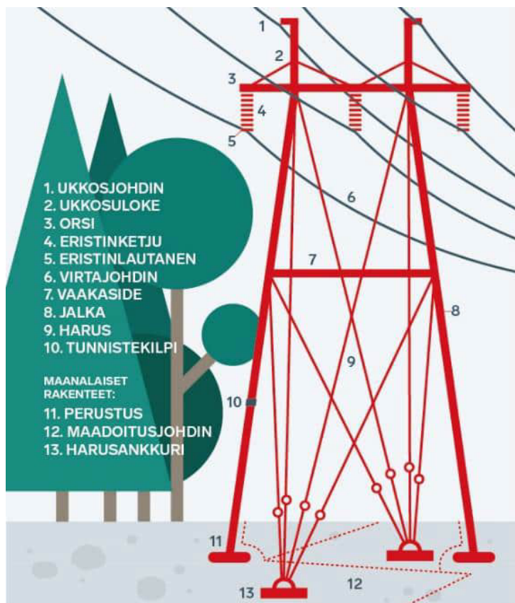
Kuva 3-5. Voimajohdon osat (Fingrid 2022b).
