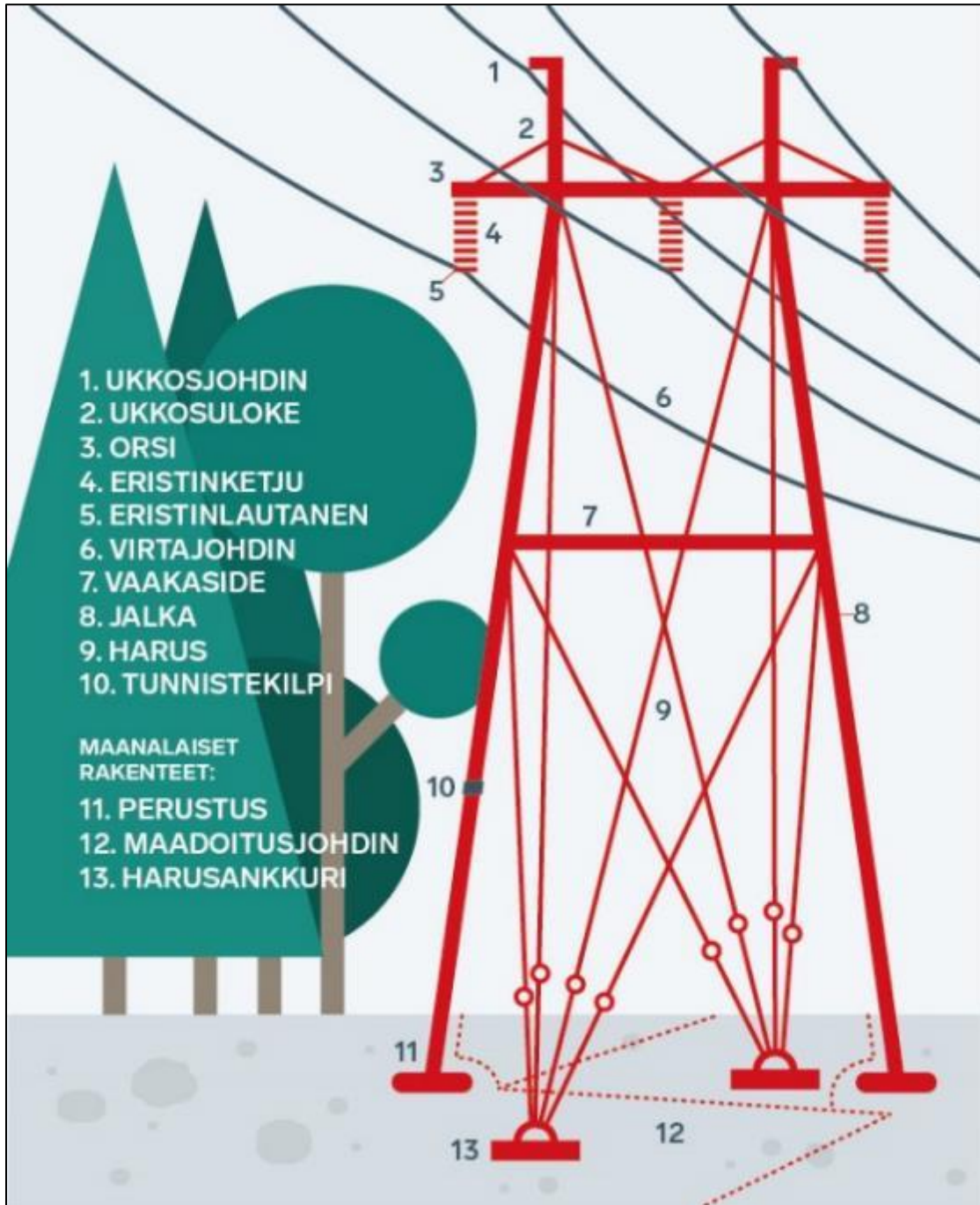
Kuva 7. Voimajohdon osat (Lähde: Fingrid 2020).
