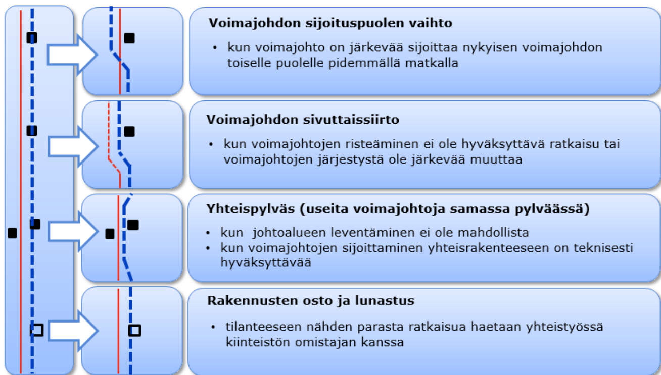
Kuva 3.2. Periaatteellisia esimerkkejä tavanomaisesta poikkeavista ratkaisuista haasteellisissa suunnittelutilanteissa. Käytettävissä olevat vaihtoehdot ovat aina tapauskohtaisia.
