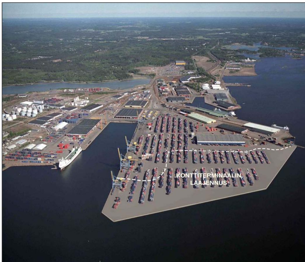
Kuva 8. Haminan sataman läjitysalueen sijoittuminen eli havainnekuva tulevasta satamarakenteesta (konttiterminaalien laajennus). Pilaantuneiden sedimenttien läjityksellä rakennetaan tulevan satamaketin itäosaan.
