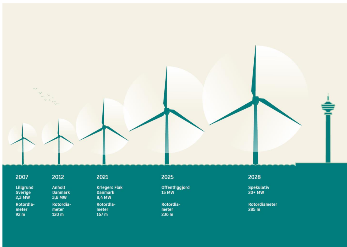
Figur 5-6. Illustration av utvecklingen av havsbaserad vindkraftsteknik från 2,3 MW 2007 till 15 MW idag och prognoser för utvecklingen av havsbaserad vindkraftsteknik under de kommande åren till mer än 20 MW. Tornet till höger i bilden visar skalan på storleken. Den totala höjden på tornet är 168 meter (OX2 2021).
