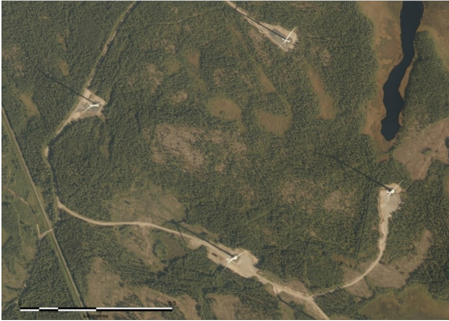
Kuva 4.1. Ilmakuvasa näkyy toiminnassa olevia tuulivoimaloita. Tuulivoimaloita varten on rakennettu huoltotiet ja nostokentät. Tuulivoimaloiden ympäristössä ja välialueilla aikaisempi maankäyttö on säilynyt ennallaan (Maanmittauslaitos). Kuva ei ole Haarasuonkankaan alueelta.
