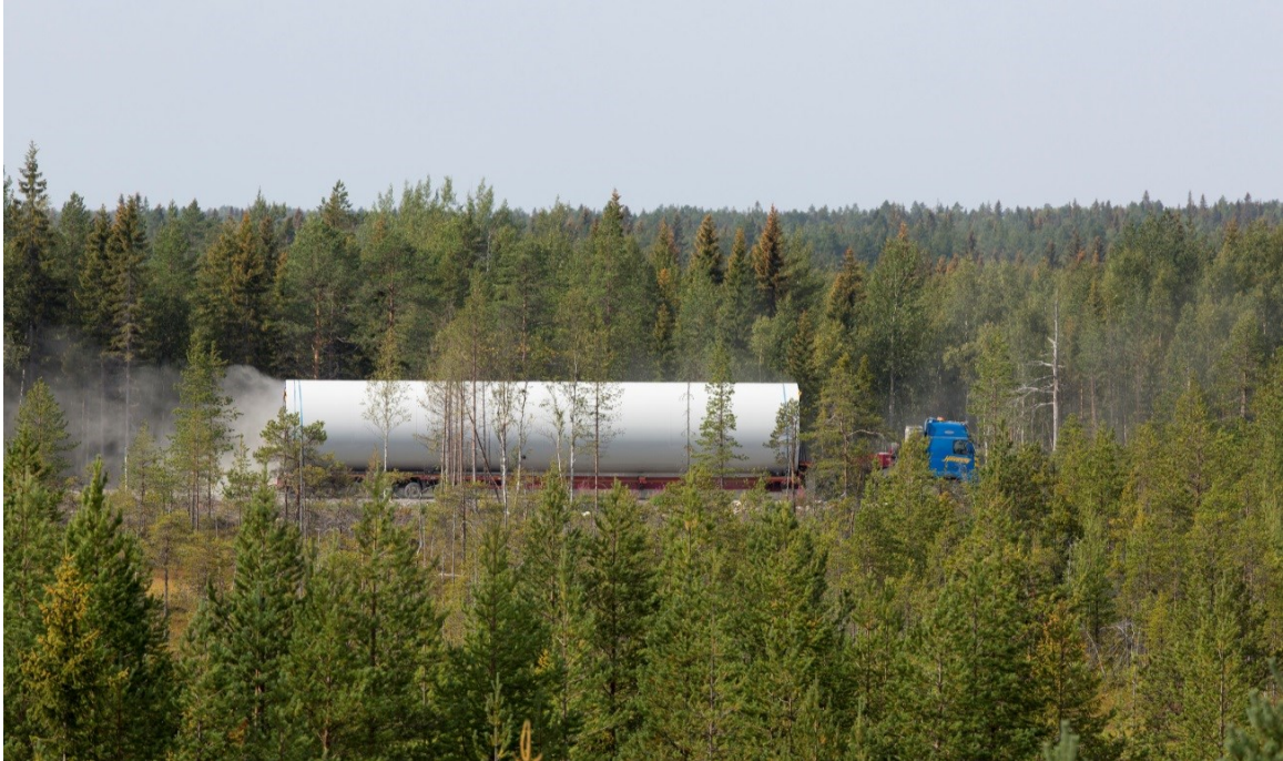
Kuva 4.16. Tuulivoimalan torniosien kuljetusta.
