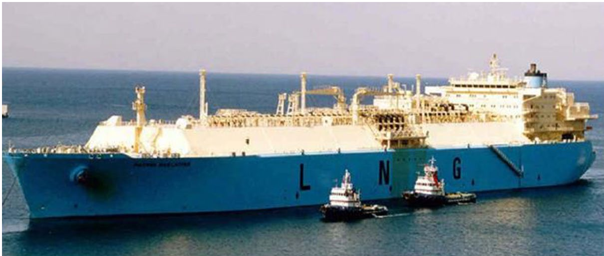
Bild 4. Exempelbild på ett 'Q-Flex' -LNG-fartyg som eventuellt används i projektet, kapacitet 165 000 m 3 , längd 285 m, bredd 43 m och djup 11 m ( http://www.vesseltracker.com ). (Källa: Pöyry Finland 2013a).
