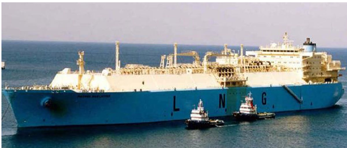
Kuva 4. Esimerkkikuva hankkeessa mahdollisesti käytettävästä 'Q-Flex' -LNG-aluksesta, kapasiteetti 165 000 m 3 , pituus 285 m, leveys 43 m ja syväys 11 m ( http://www.vesseltracker.com ). (Lähde: Pöyry Finland 2013a).
