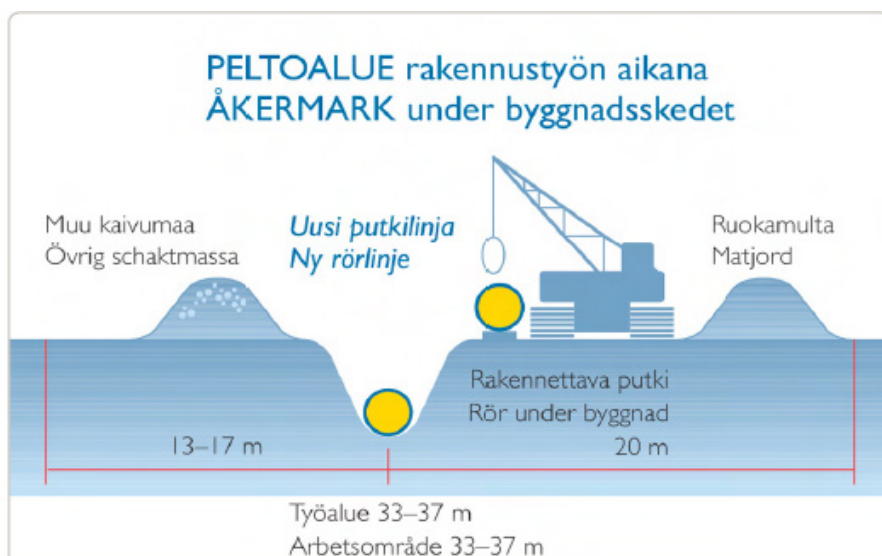
Bild 9. Arbetsområde för byggnad av naturgasröret i skogsmark (övre bilden) och på åkermark (nedre bilden). (Källa: Pöyry Finland 2013a).
