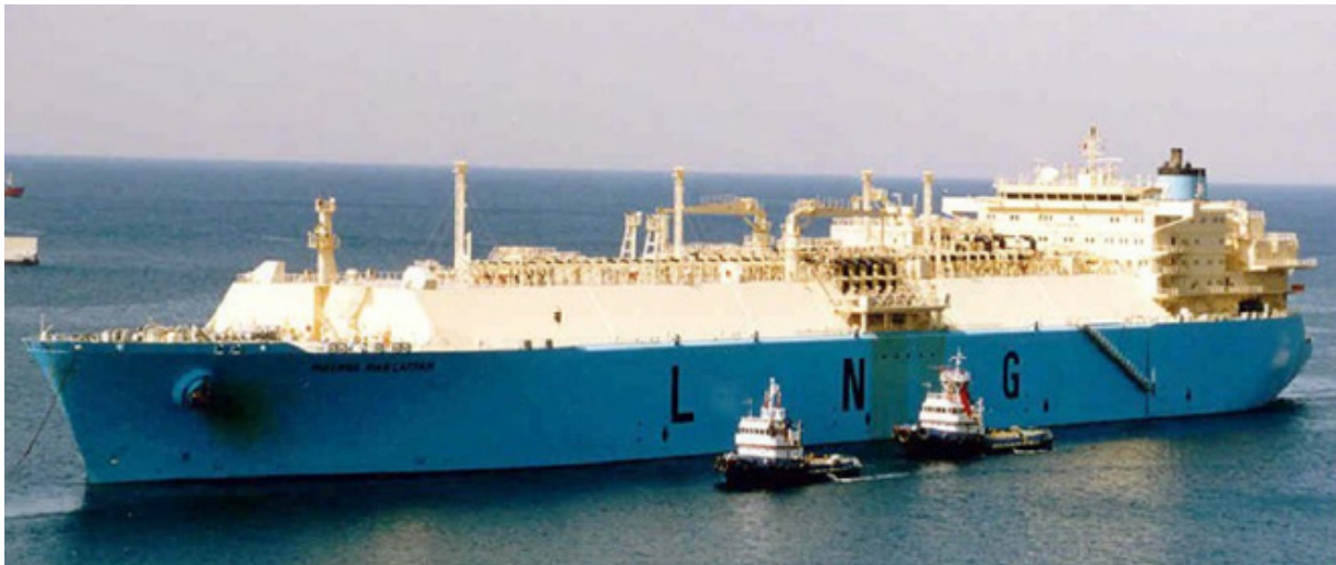
Bild 6. Exempelbild på ett 'Q-Flex' -LNG-fartyg som används i projektet, kapacitet 165 000 m 3 , längd 285 m, bredd 43 m och djup 11 m ( http://www.vesseltracker.com ). (Källa: Pöyry Finland 2013).
