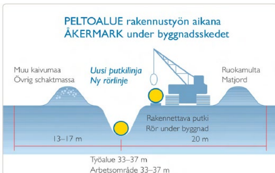
Kuva 9. Maakaasuputken vaatima työalue metsäosuuksilla (ylempi kuva) ja pelto-osuuksilla (alempi kuva). (Lähde: Pöyry Finland 2013a).
