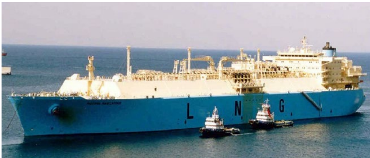
Kuva 6. Esimerkkikuva hankkeessa käytettävästä 'Q-Flex' -LNG-aluksesta, kapasiteetti 165 000 m 3 , pituus 285 m, leveys 43 m ja syväys 11 m ( http://www.vesseltracker.com ). (Lähde: Pöyry Finland 2013).
