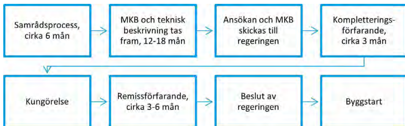
Figur 37. Exempel på schematisk tidplan för prövningsprocessen med uppskattade tider för vindkraftspark i svensk ekonomisk zon.
