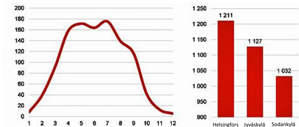
Bild 1.5 Genomsnittliga månatliga strålningsnivåer på en yta riktad i 45 graders vinkel mot söder i Finland (till vänster) och skillnader i årliga strålningsnivåer i olika städer (till höger) (bild: Motiva 2024a).
