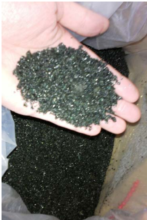
Kuva 8. BtL-tehtaalla kaasutusvaiheessa syntyvä tuhka.
