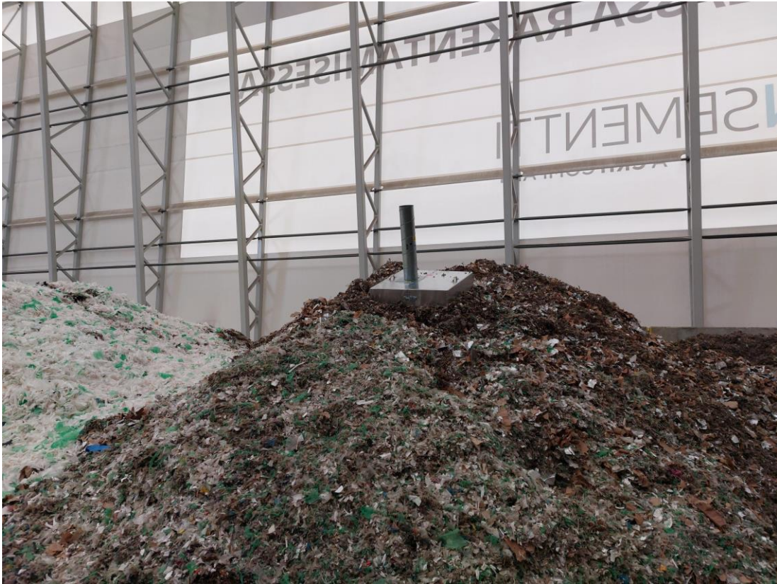
Kierrätyspolttoaine (SRF). Näytteenottopaikka 1. Kuvassa näytteenottohuuva.
