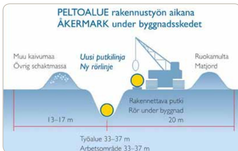
Kuva 20. Maalle rakennettavan maakaasuputken vaatima työalue pelto-osuuksilla
