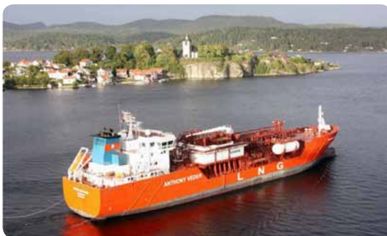
Kuva 9. Esimerkkikuva pienemmästä LNG-aluksesta, kapasiteetti 7 500 m 3 , pituus 117 m, leveys 19 m, syväys 5,8 m. (kuva: www.shipspotting.com )
