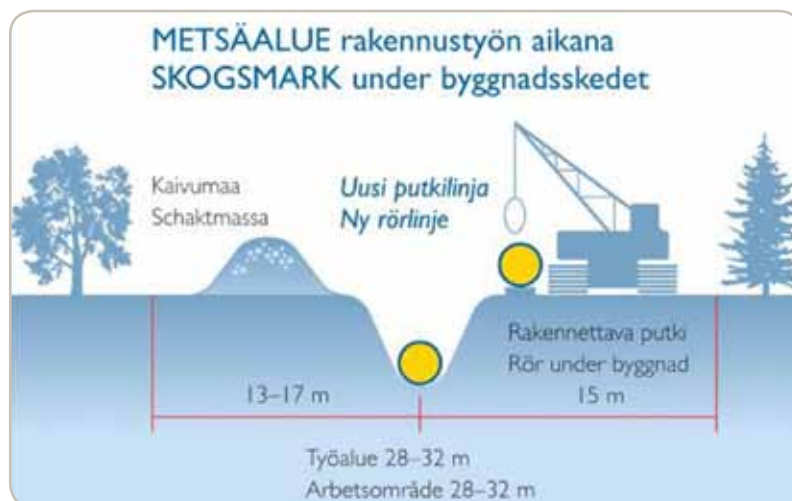
Kuva 19. Maalle rakennettavan maakaasuputken vaatima työalue metsäosuuksilla
