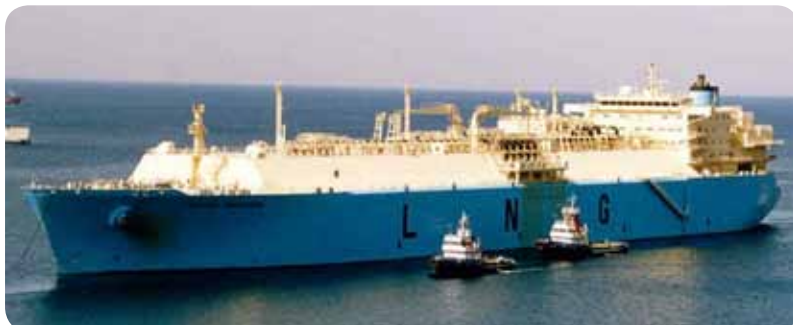
Kuva 7. Esimerkkikuva hankkeessa käytettävästä 'bench mark'-LNG-aluksesta, kapasiteetti 165 000 m 3 , pituus 285 m, leveys 43 m ja syväys 11 m (kuva: www.vesseltracker.com )
