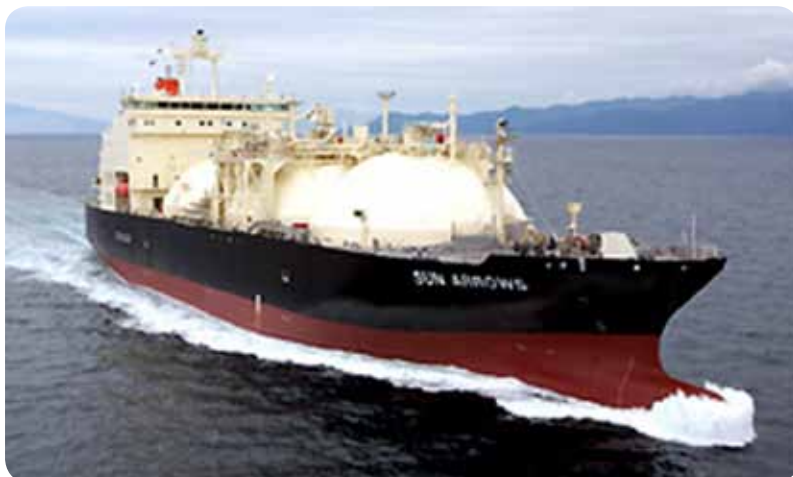
Kuva 8. Esimerkkikuva pienemmästä LNG-aluksesta, kapasiteetti 19 177 m 3 , pituus 151 m, leveys 28 m, syväys 7,6 m. (kuva: www.vesseltracker.com ).
