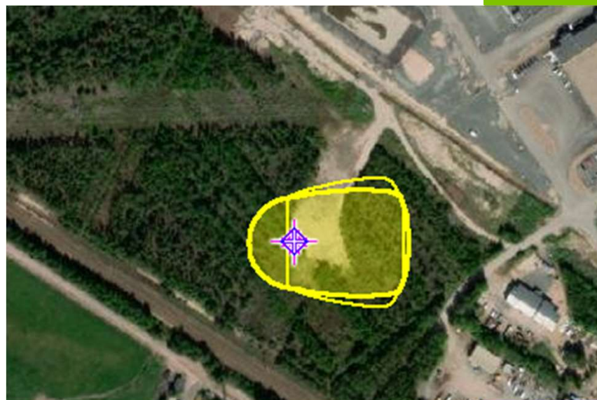
Kuva 15. Vetyperoksidisäiliön vuoto. Keltaisella kuvattu PAC-1 leviäminen länsituulella. Alueen vallitsevat tuulensuunnat ovat lännestä ja lounaasta (85 m).
