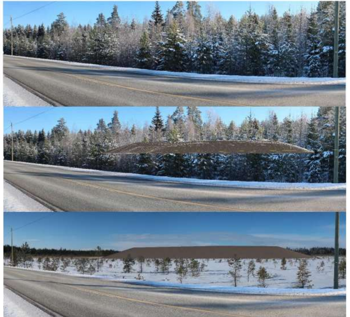
Kuva 13-4. Näkymä seututieltä 694 (kuvauspiste 2) kohti hankealuetta. Ylimmässä kuvassa on kuvanottohetken tilanne. Keskimmäisessä kuvassa on maankaatopaikan täytön rautalankamalli lopputilanteessaan mallinnettuna kuvaan, jossa puusto peittää näkyvyyden täyttöalueelle kokonaisuudessaan (VE1 ja VE2). Alimmassa kuvassa maankaatopaikan täyttö mallinnettuna kuvitteellisessa tilanteessa, jossa korkea puusto on poistettu mallinnuksesta (VE1 ja VE2).
