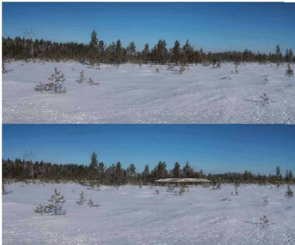
Kuva 13-3. Näkymä Karvasuolla kulkevalta reitiltä (kuvauspiste 1) kohti hankealuetta. Yläkuvassa on kuvanottohetken tilanne. Alakuvassa on maankaatopaikan täytön rautalankamalli lopputilanteessa mallinnettuna kuvaan, jossa puusto peittää näkyvyyden täyttöalueelle kokonaisuudessaan (VE1 ja VE2).
