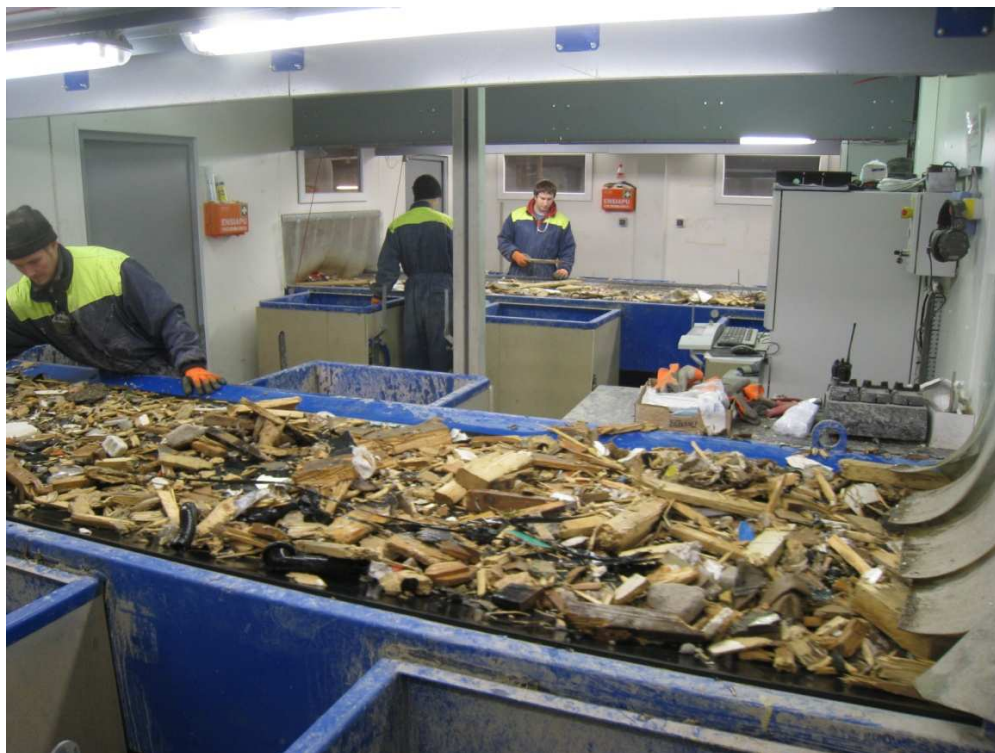
Kuva 2. Rakennus- ja energiajätteen lajittelua manuaalisesti. (Kuva: Kuusakoski Oy).
