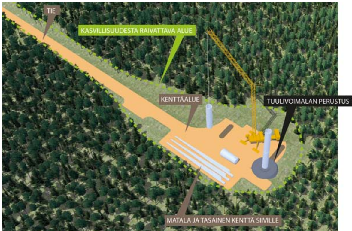
■ Kuva 7-4. Periaatekuva tuulivoimalan kokoamis- ja pystytysalueesta (TuuliWatti Oy).
