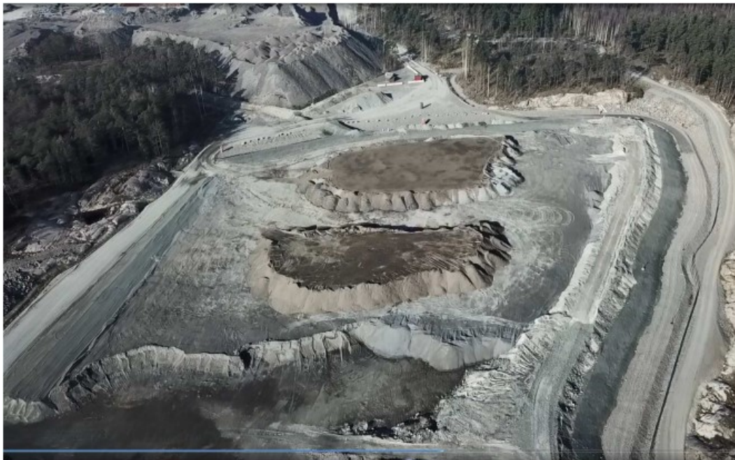
Kuva 6.5-3. Kuonan varastointikasa (465 000 t) Oxelösundissa.
