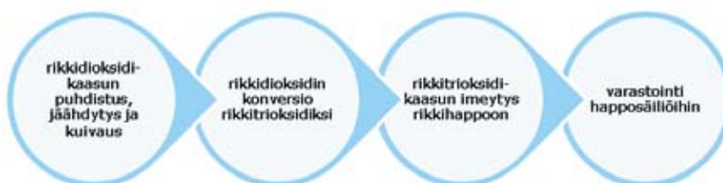
Kuva 3. Rikkihappotehtaan prosessivaiheet.
