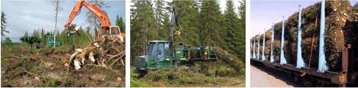
Kuva 6 Kantojen nosto, metsätähteen paalaus ja paalien kuljetus.
