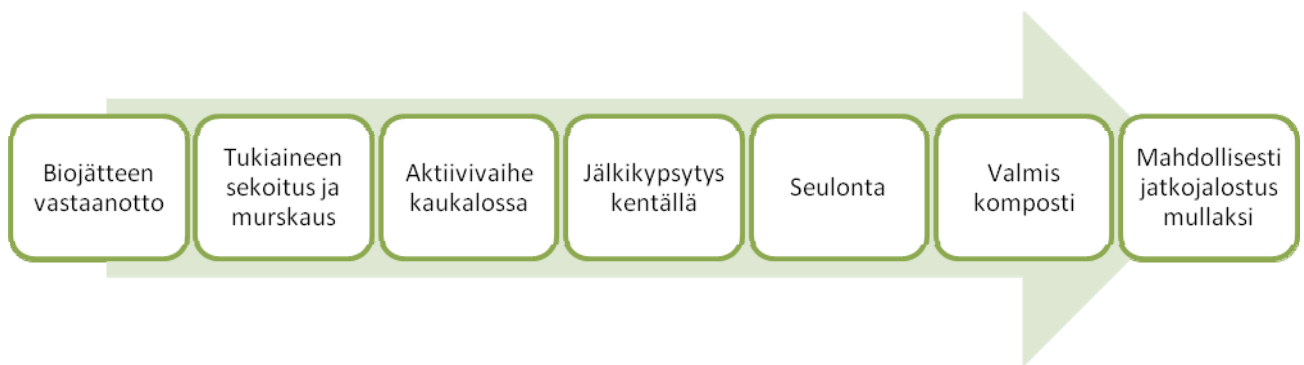
Kuva 9. Biojätteen käsittely kompostoimalla.
