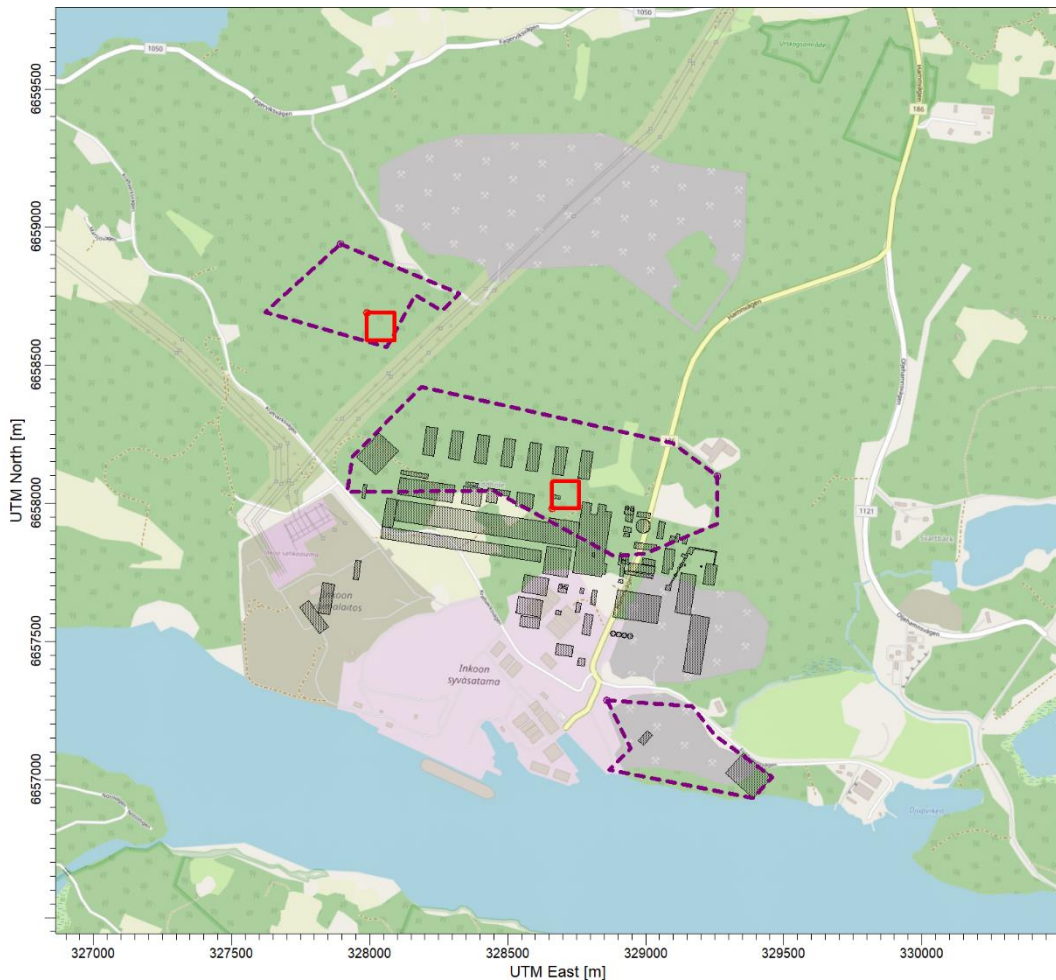
Bild 5. Förmodade utsläppskällor vid modellering av partikelutsläpp under konstruktion: förmodade platser för två krosstationer markeras med röda fyrkanter och gränserna för de områden som ska jämnas ut genom schaktning eller grävning med en lila prickad linje.
