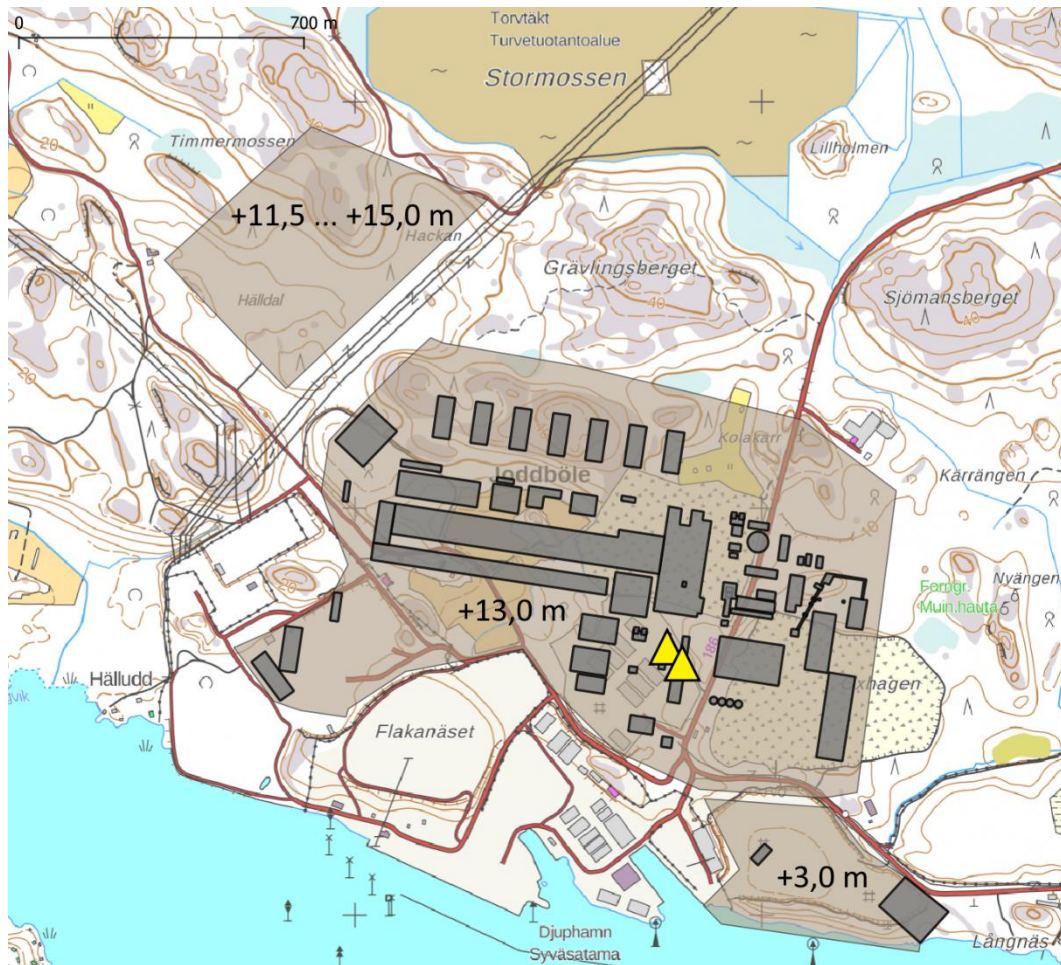
Bild 2. Planerade byggnader som ingår i modellen för spridning av luftutsläpp (i mörkgrått) och områden som planeras att jämnas ut (i brunt, slutliga terränghöjder anges). De två skorstenarna som utsläppskällor är markerade med gula trianglar. Kartmall: Lantmäteriverkets terrängkarta.
