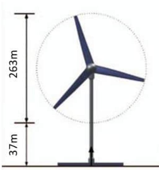
Figur 4. Figuren visar vindturbinernas storlek i den preliminära produktionsanalysen. Totalhöjden är 300 m.
