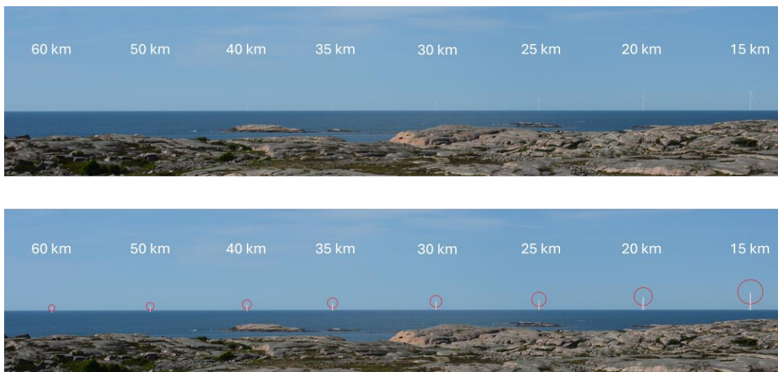
Figur 7-10. Figuren visar genom fotomontage hur ett 370 meter högt vindkraftverk upplevs på varierande avstånd (15–60 kilometer). Sikten är klar och betraktaren står 28 meter över havsnivån. De röda cirkklarna i nedre bilden representerar rotorbladen. Bild från Bilaga 10.
