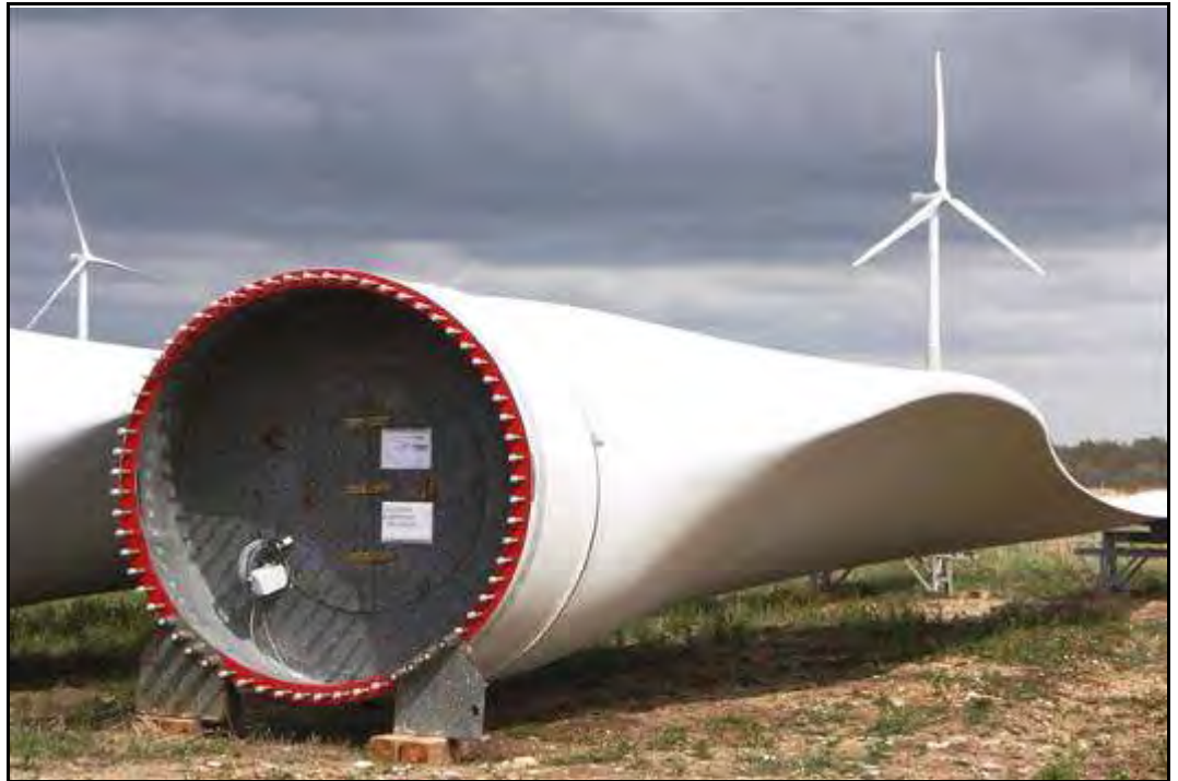
Kuva 4.16. WinWinD:n 3 MW turbiinin lapa (WinWinD).
