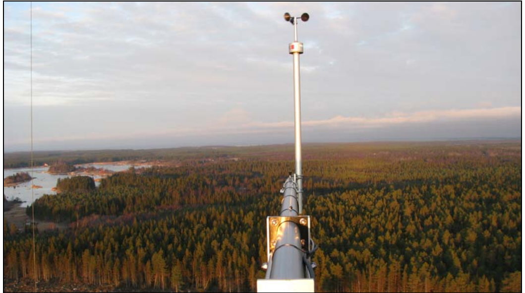
Kuva 6.22. Granössä sijaitsevan mittausmaston päässä on mm. anemometri, jolla mitataan tuulen nopeutta.
